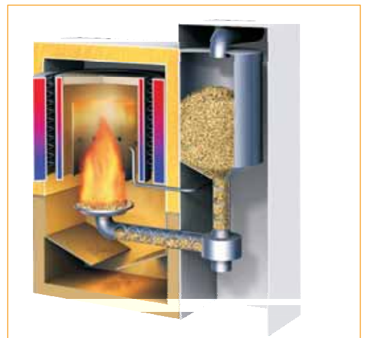
Kleiner Pelletofen mit integriertem Pelletvorrat
